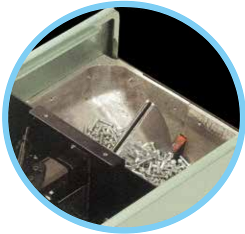
ねじが傷つきにくいホツパ機構
