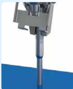
エア吸着により、スクリーガイド内にねじを保持します。狭い箇所やザグリ穴、段差での締結に適し、汎用性があります。
